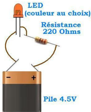
[7] Schéma du montage d'une led avec une pile
