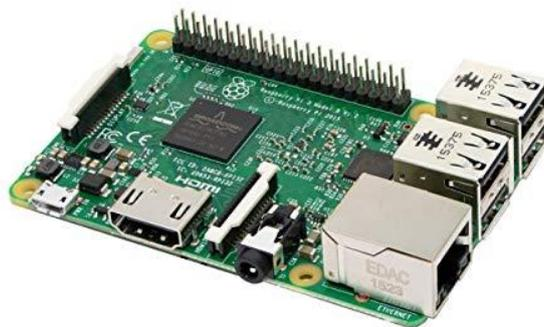
[17] Photo d'une Raspberry pi 3 modèle B
